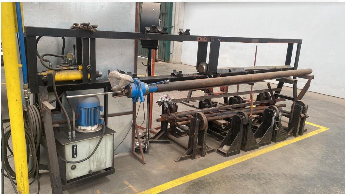
MÁQUINA DE TRANSFORMAR TUBO CILINDRO – (ITEM 32 NA LISTA)
